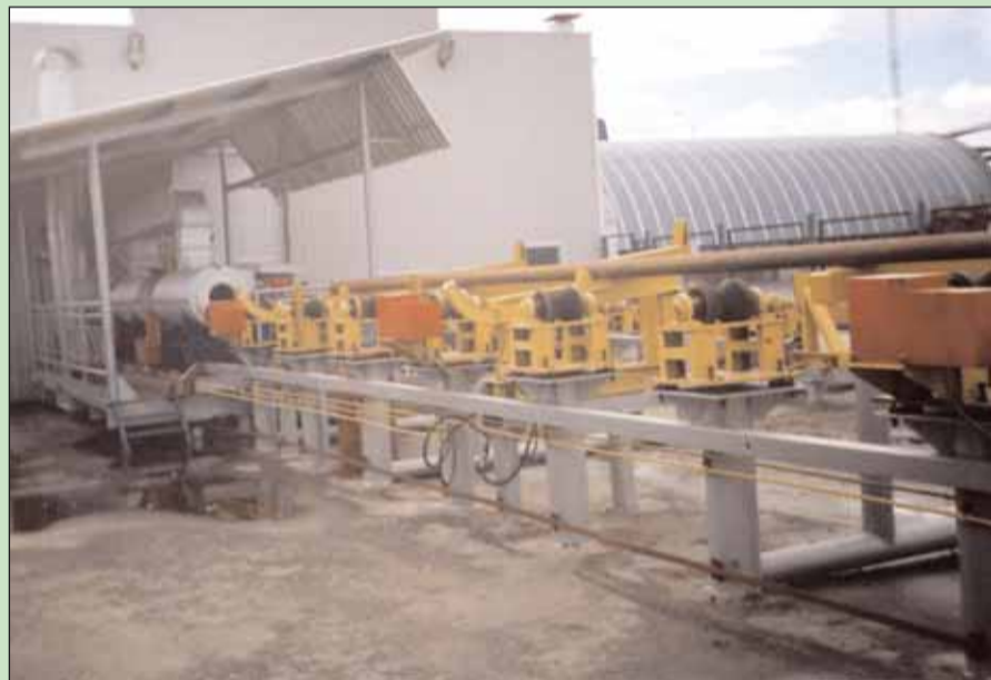
Фрагменты линии изоляции труб с преобразователями «Веспер» на одном из предприятий «Сургутнефтегаз». На фото сверху: рольганги приемного участка
