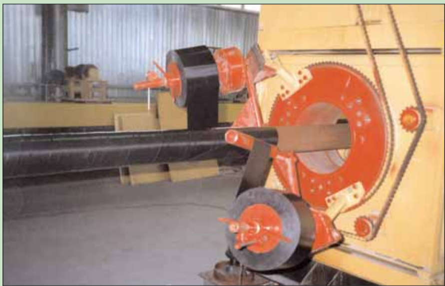
На фото сверху: узел нанесения изоляционного покрытия на трубу. На фото внизу и справа: шкафы управления линией с размещенными в них преобразователями частоты и Дистанционный пульт управления и контроля
