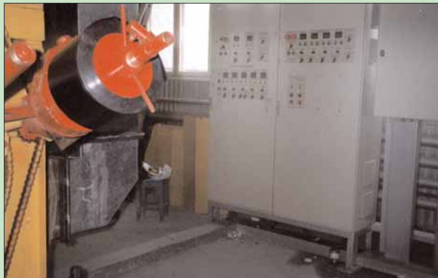
На фото сверху: узел нанесения изоляционного покрытия на трубу. На фото внизу и справа: шкафы управления линией с размещенными в них преобразователями частоты и Дистанционный пульт управления и контроля
