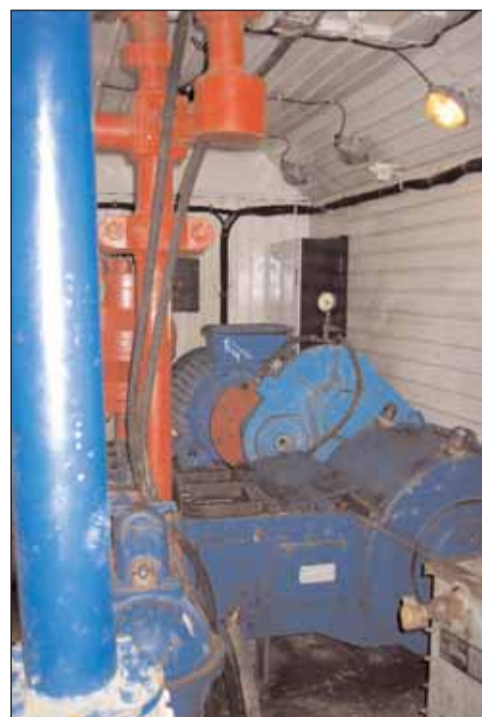
Отсек бурового насоса с преобразователем частоты
